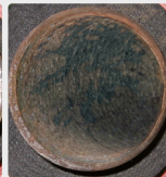
Kalk mit Biofilm im Rohr
