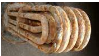
Tubería de un intercambiador de calor
