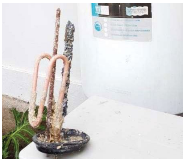
Tras la instalación del sistema anticalcáreo Vulcan, las incrustaciones pequeñas restantes son blandas y se eliminan fácilmente.
