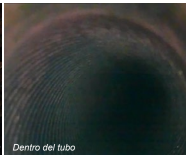
Enfriador del condensador #3 Ø 67 cm, tubo Ø 7/8", longitud: 418 cm
