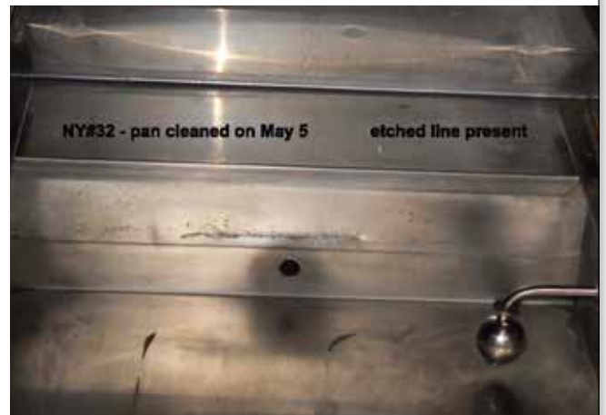
Después de la instalación de Vulcan: el área de la bandeja ahora está totalmente libre de cal. Se observa una leve hendidura en la línea de flotación de la bandeja.
